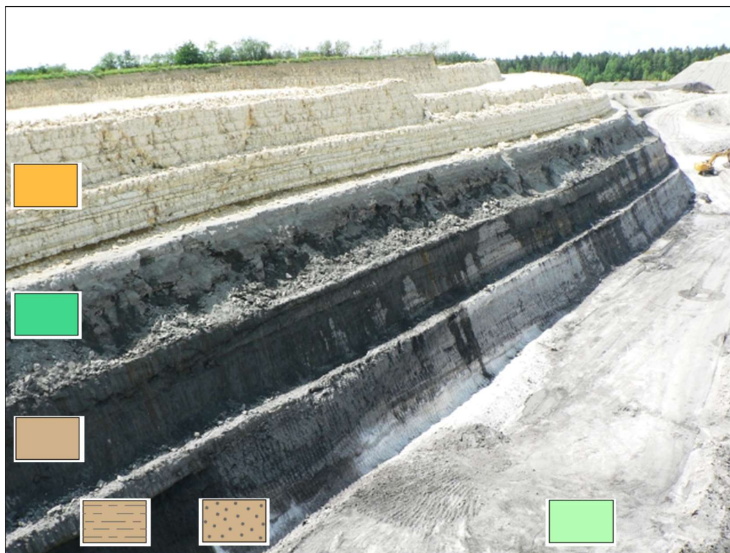
Pohled na jižní stěnu lomu Babín-sever od V: kompletní profil ve skrývkových řezech v křídě. Povrch spodní etáže tvoří hlava nýřanských vrstev (červen 2020). Vysvětlivky viz příloha č. B 4/0.
